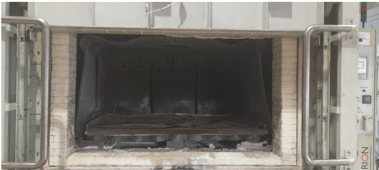
Abb.3 Ofen zum Schmelzen/ Erhitzen von Metall/ Metallschaum
