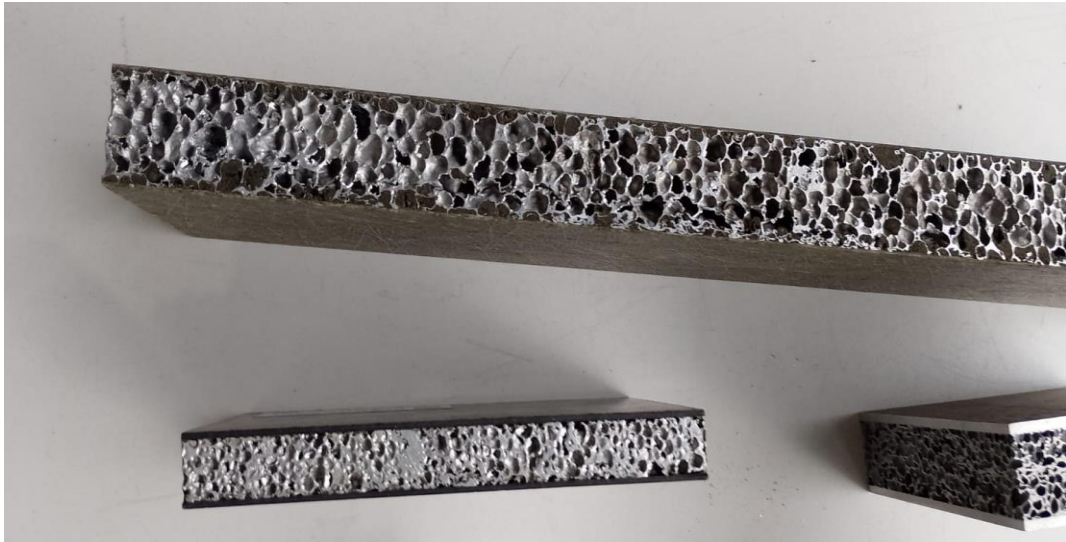
Abb.4 Metallschaum in der Sandwich Methode hergestellt mit der pulvermetallurgische Prozesskette
